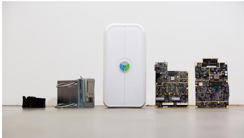
图 5-1 OpenCellular 组件：套板、安装支架、外壳、射频电路板、GBC 电路板
